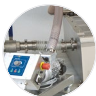
Pompa połączona z sitem (wąż w zestawie)
