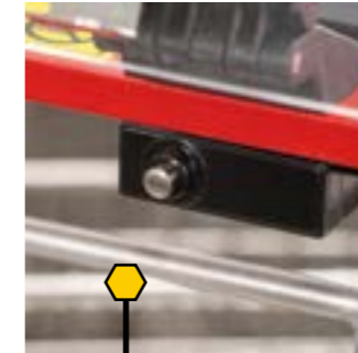
Blokada bezpieczeństwa - otwarcie pokrywy powoduje zatrzymanie miodarki.
