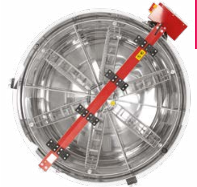
Bęben o wysokości 735 mm wykonany ze stali nierdzewnej, dna stożkowe, dwa zawory 2".
